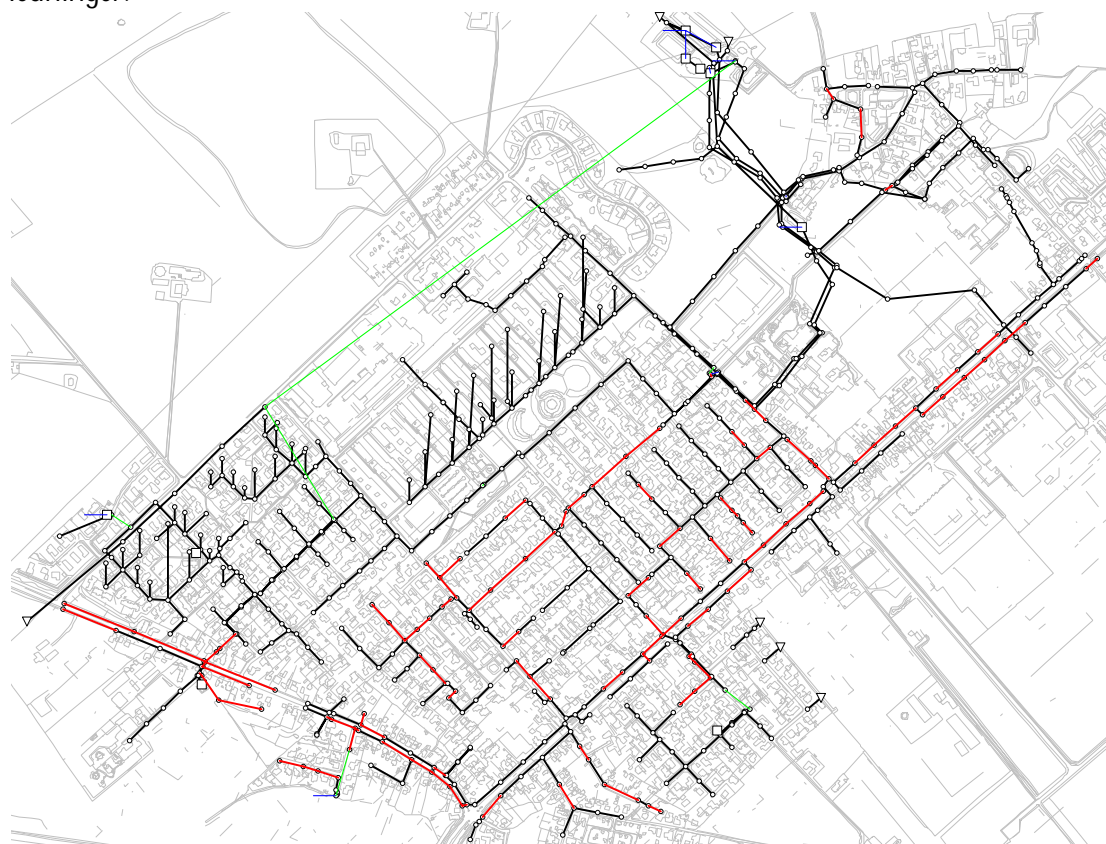
Figur 5 Røde ledninger: Selvrensningsevnen vurderet utilstrækkelig (jvf. tekst), \tau < 1,75 \text{ N/m}^2 .
