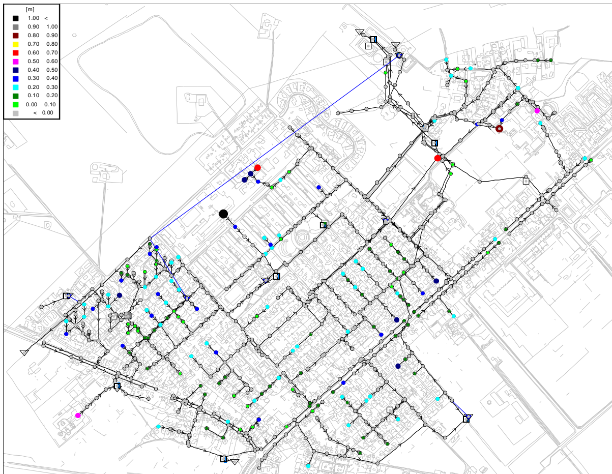
Figur 7. Planberegning CDS regn, T=5 år. Opland separatkloakeret. Anvendt sikkerhedsfaktor 1,57 (i.e. inkl. klimatillæg). Vær opmærksom på betydelig beregningsmæssig opstuvning ved industriarealet (stor sort prik). Afledning herfra er ikke opdimensioneret.
